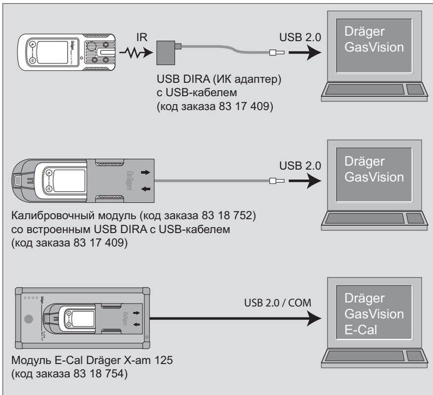
Для считывания и отображения данных из памяти прибора используется установленная программа для ПК "Dräger GasVision".
