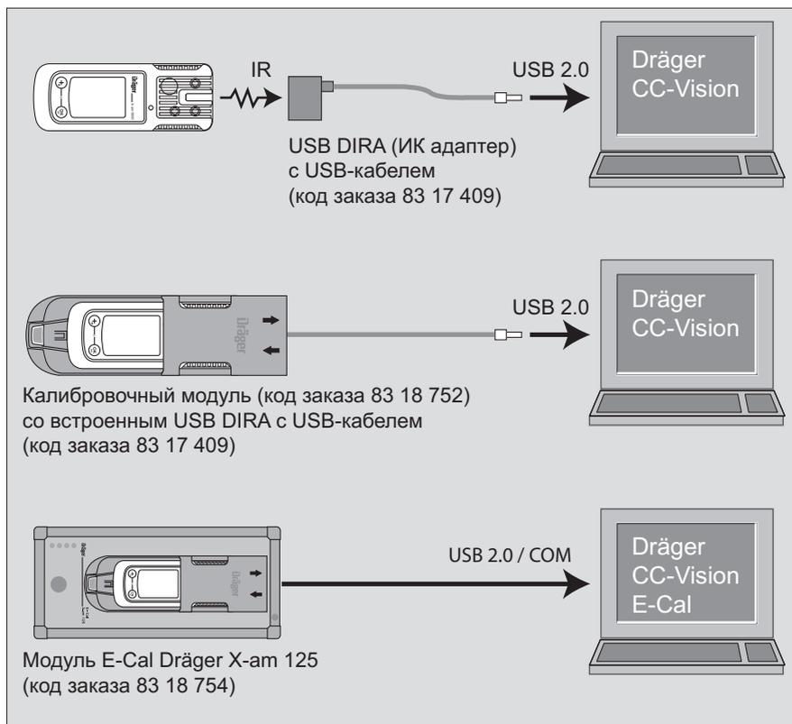
Для конфигурирования используется установленная на ПК программа "Dräger CC-Vision".
